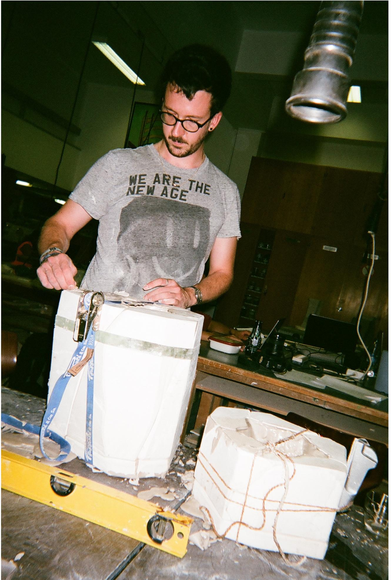
**J'effectue ici le moule d'une pièce imprimée pour ensuite y faire des tests de coulage d'argile liquide.**
