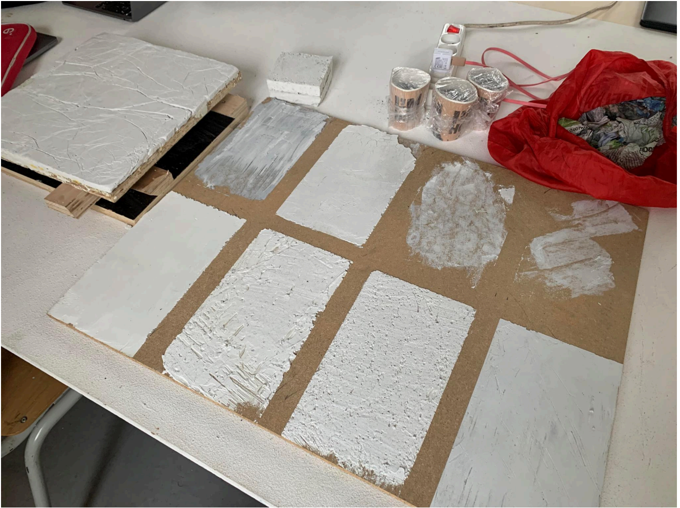
Recherches sur la substitution du calcaire utilisé pour produire de la chaux par des déchets de coquille de moules. © Lucas Sabatier
